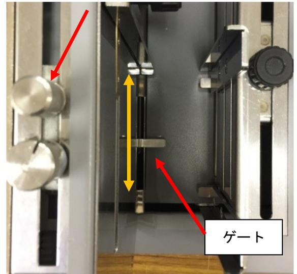
ゲート部がタグの中心にくるように位置調整を行い、ネジを締めて位置を固定させます。
