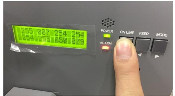
電源が切れている状態で、左のボタンを押しながら電源を入れ、数字が出てきたら指を離して下さい。
