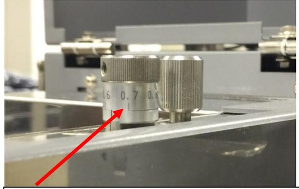
上のダイヤルを回すと下のゲート部が上下します。
